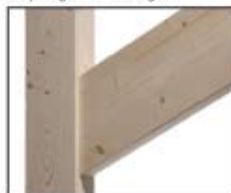
Vertikal nach oben geneigter Anschluss/Stütze-Riegel.
